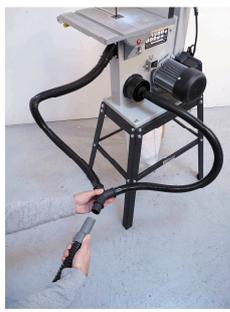
Connexion du double système d'aspiration
