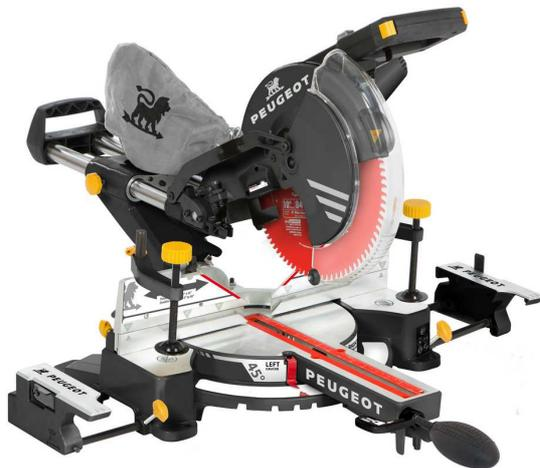
Die EnergySaw-254SB ist auf eine komfortable Bedienung ausgelegt, angefangen bei der Positionierung des Schrägschnittkopfes links und rechts mit dem Bedienhebel auf der Frontplatte. Der Anschlagindex (Trigger) der Aluminiumplatte wird durch Anschlag in den Hauptwinkeln von 0° bis 45° verstellt.
