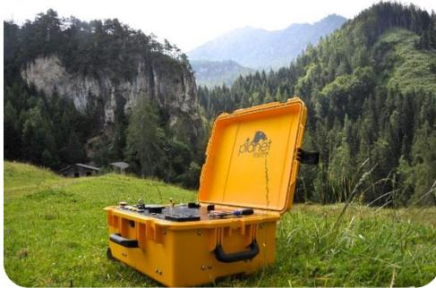
Quantum-RX présente le PLANET, le tout nouveau diffractomètre de rayons X (DRX) portable du fabricant allemand Xplorex GmbH (représentation exclusive). Cet analyseur à haute-résolution a été conçu pour répondre aux besoins d'identification in situ des poudres, et particulièrement des mélanges de minéraux complexes, pour les applications en géologie et minéralogie.
